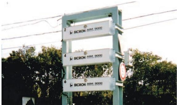
製鋼メーカーへ20年前に納入した当時で国内最大級の検知機
